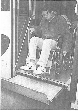
写真2 リフト付バス 高齢者や障害者の利用を考慮してバス車両の改善がすすめられている。車いす使用者がそのまま乗降できるリフト付バスや床を低くした低床式バスに、さらに床を下げるニーリング装置により乗降しやすくするなど、研究開発の成果が普及していくことを期待したい
