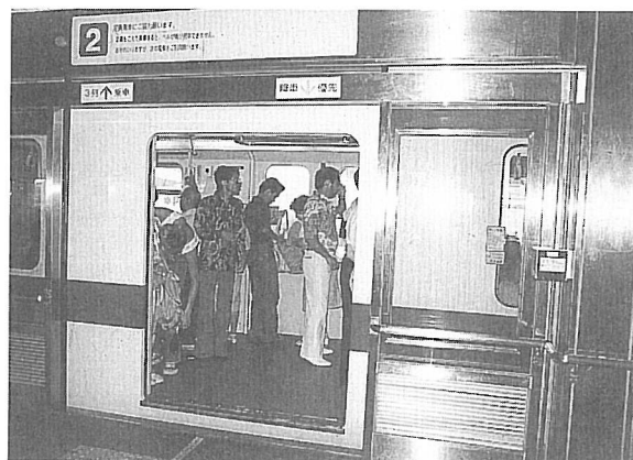
写真1 全国で初めて導入された神戸の新交通システム、ポートルライナー コンピューター制御による無人運転であるが、乗降スペース等の安全化が図られている
