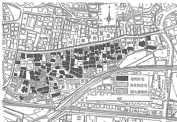
図7・2 川面3丁目地区の従前建物状況
